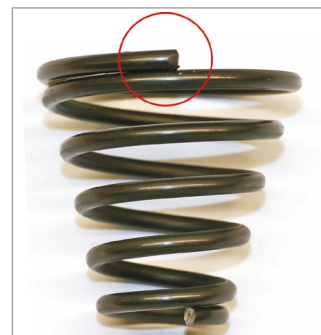
▲ Konische Feder hergestellt mit motorisch verstellbaren Windestiftalter (PTP-Windefinger)
