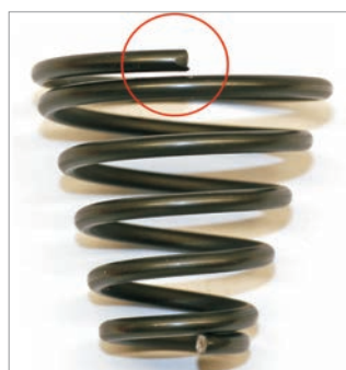
▲ Konische Feder hergestellt ohne PTP-Windefinger
