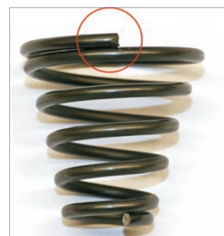
▲ Konische Feder hergestellt mit PTP-Windefinger
