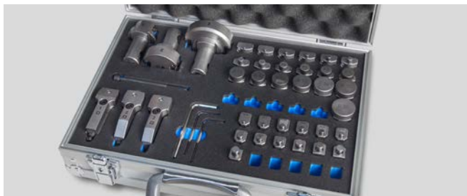
▲ Werkzeugset mit Biegedorn- und Biegestifthaltern in drei verschiedenen Größen (G1, G2 und G3) sowie den dazugehörigen Biegedorn- und Biegestifteinsätzen
