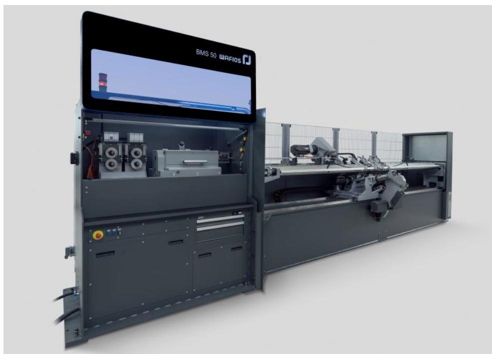
Abb. 1 BMS 50 mit Sicht auf den Einzugsbereich bei offener Schutzhaube
