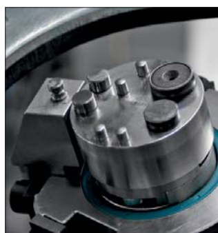
▲ Mehrradien-Biegewerkzeug zum Biegen und Freiformen
