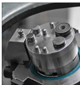
▲ Mehrradien-Biegewerkzeug zum Biegen und Freiformen
