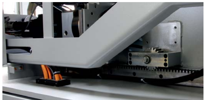
▼ Einzug samt Richtwerk komplett versetzbar
