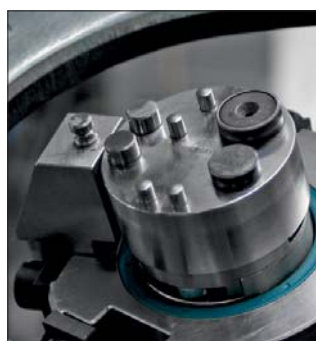
▲ Mehrradien-Biegewerkzeug zum Biegen und Freiformen
