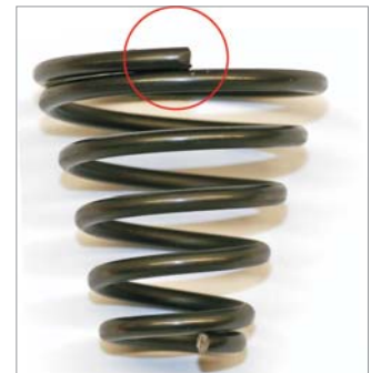
▲ Konische Feder hergestellt mit PTP-Windefinger
