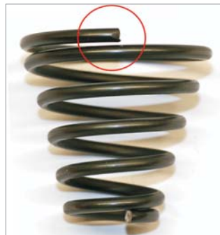
▲ Konische Feder hergestellt ohne PTP-Windefinger
