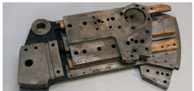
▲ Wickelplatte vor Reparatur
