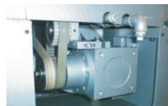
▲ Alter Einzugsantrieb: Variducer
