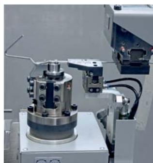
▲ Greifer mit Schwinde in Verbindung mit Biegewerkzeug (Biegekopf oben)
