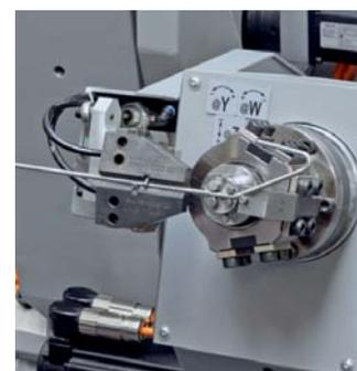
▲ Greifer mit Schwinde in Verbindung mit Biegewerkzeug (Biegekopf unten)
