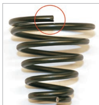
▲ Konische Feder hergestellt ohne motorisch verstellbaren Windestifthalter (PTP-Windefinger)
