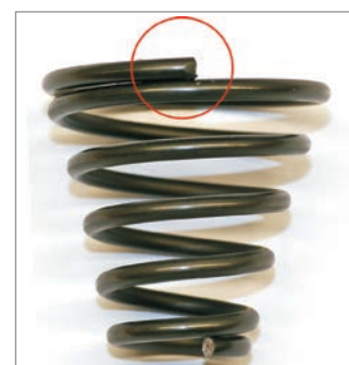
▲ Konische Feder hergestellt mit motorisch verstellbaren Windestifthalter (PTP-Windefinger)
