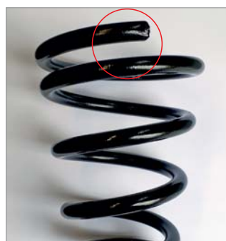
▲ Konische Feder hergestellt ohne PTP-Windefinger
