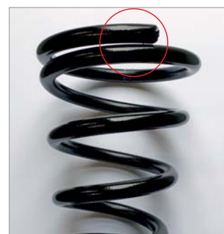
▲ Konische Feder hergestellt mit PTP-Windefinger
