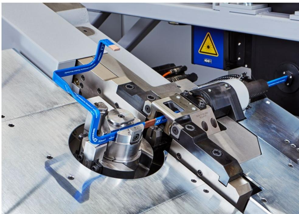
Abb. 4 WAFIOS BMF 60 Biegebereich Stromschiene
