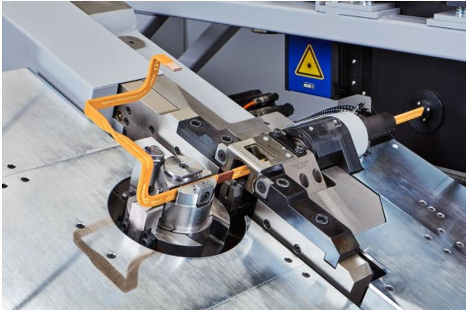
Abb. 2 Stromschiene auf der BMF 60
